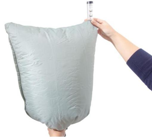
**2.2** Setzen Sie das Kopfteil in den Beutel ein und starten Sie das Gebläse. Greifen Sie den Beutel, um ihn rund um den Atemschlauch abzudichten. Halten Sie mit der anderen Hand das Durchflussmesserrohr so, dass es vom Beutel nach oben zeigt.
