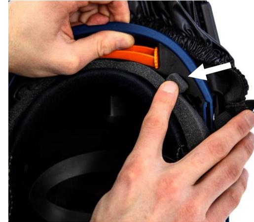
**8.3** Montieren Sie die neue Stirndichtung. Drücken Sie die Laschen der Stirndichtung in die Fassung des Helmes.
