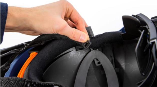
**8.2** Entfernen Sie die Stirndichtung.
