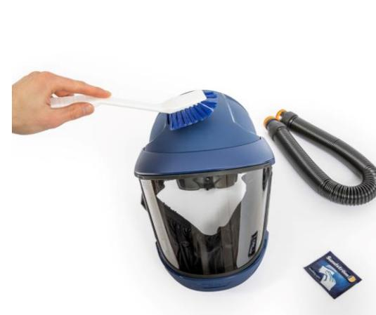
**12.1** Verwenden Sie bei stärkeren Verschmutzungen eine weiche Bürste oder einen Schwamm, der mit einer Lösung aus Wasser und Reinigungsmittel o. Ä. angefeuchtet wurde. Abspülen und trocknen lassen.
