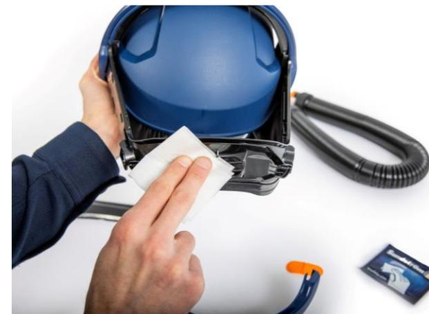
**12.2** Nettoyez la membrane d'expiration et le siège de la soupape. Vérifiez que tout va bien.
