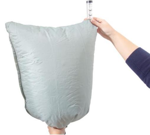
**2.2** Placez l'équipement de protection respiratoire dans le débitmètre et démarrez l'unité de ventilation. Serrez le sac pour assurer l'étanchéité autour du tuyau respiratoire. Saisissez le tube du débitmètre avec l'autre main, le tube pointera vers le haut du sac
