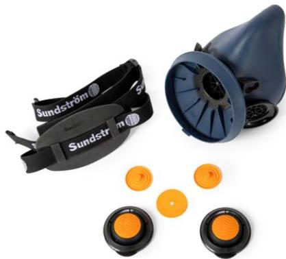
**9.1** Filter, Klappen für Ausatemventile und Membrane, Einatemmembran und Kopfgestell entfernen. (Optional kann das Kopfgestell gewaschen werden, dafür aber gesonderte Trockenzeiten einplanen)
