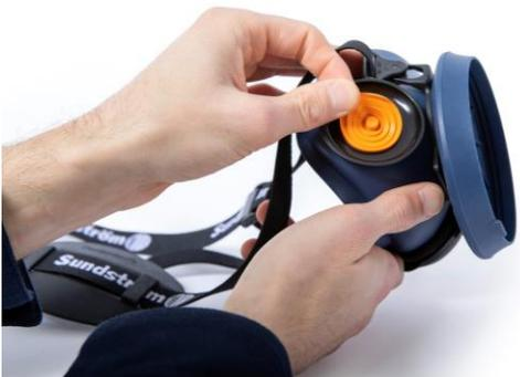
**8.3** Neue Membrane auf Zapfen aufstecken. Vergewissern Sie sich, dass die Membrane rundum Kontakt mit den Membransitzen haben.
