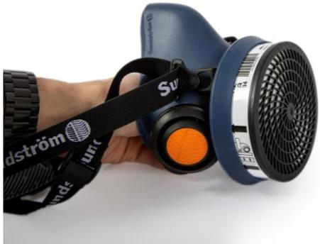
**2.1** Monter le filtre ou le filtre combiné sur le masque de sorte que les flèches tracées sur le filtre soient tournées vers le visage de l'utilisateur. Vérifiez avec soin que le bord du filtre est positionné dans la cannelure intérieure de la monture du filtre sur tout son pourtour
