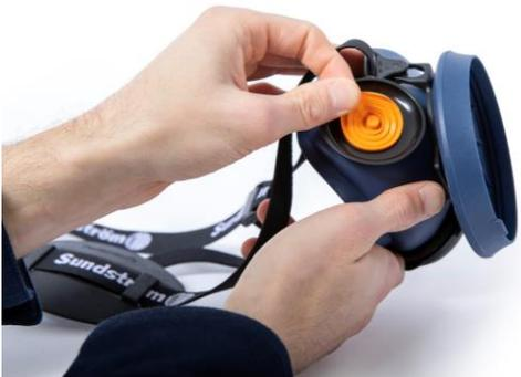
**8.3** Presser la nouvelle membrane sur les goupilles. Assurez-vous que les membranes s'appliquent exactement sur le pourtour du siège de la membrane.
