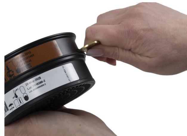
**1.4** Pour séparer un filtre combiné, placez une pièce de monnaie dans l'espace entre la lèvre inférieure du filtre à particules et le petit onglet moulé sur le côté du filtre à gaz. Poussez fermement et faites levier avec la pièce jusqu'à ce que le filtre se désolidarise.
