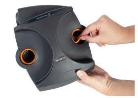
**12.1** Les joints comportent une gorge circulaire et sont emboîtés sur une bride située sous le filetage du porte-filtre. Sortir le joint usé.
