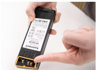
**11.4** Nettoyage du joint d'étanchéité de la batterie.
