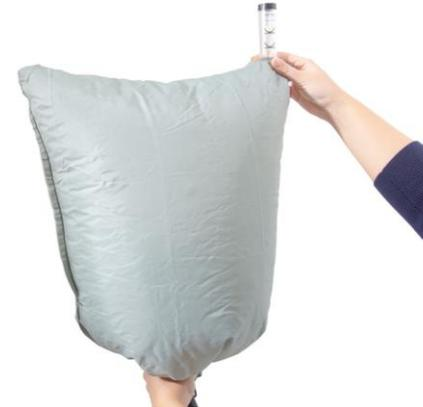
**2.3** Coloque el equipo facial en la bolsa del flujómetro y encienda el ventilador.
