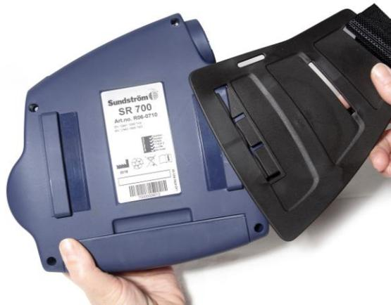
**2.2** Stellen Sie das Gebläse auf den Kopf. Der Gürtel muss so montiert werden, dass er nach oben weist. Setzen Sie die drei Zungen der Gürtelhälfte halb in den Schlitz des Gebläses ein. Beginnen Sie mit der obersten Zunge, und drehen Sie dann den Gürtel in das Gebläse.
