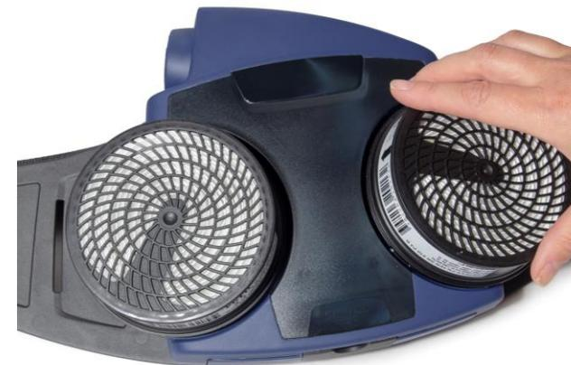
**3.3** Schrauben Sie den Filter in die Filterfassung ein, bis der Adapter an der Dichtung anliegt. Drehen Sie ca. 1/8 Umdrehung weiter, um eine gute Abdichtung zu gewährleisten.
