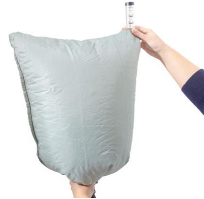
**6.3** Platzieren Sie das Kopfberteil in den Strömungsmesser, und fassen Sie den Beutel so unten an, dass er um den oberen Anschluss des Atemschlauchs abdichtet.
