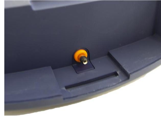
**1.3** Kontrollieren, dass die Dichtung bei dem Ladekontakt intakt ist.
