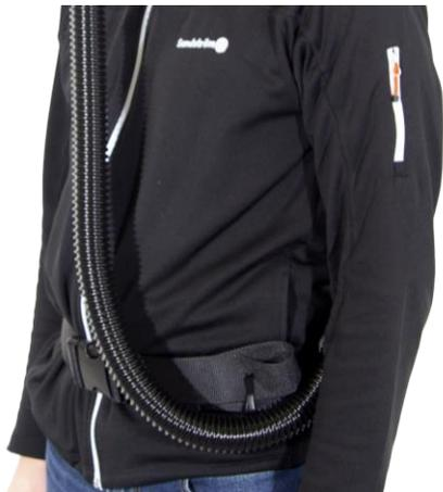
**8.6** Beachten Sie, dass der Schlauch bei Verwendung einer Vollmaske um die Taille herum und an der Brust nach oben geführt werden muss.
