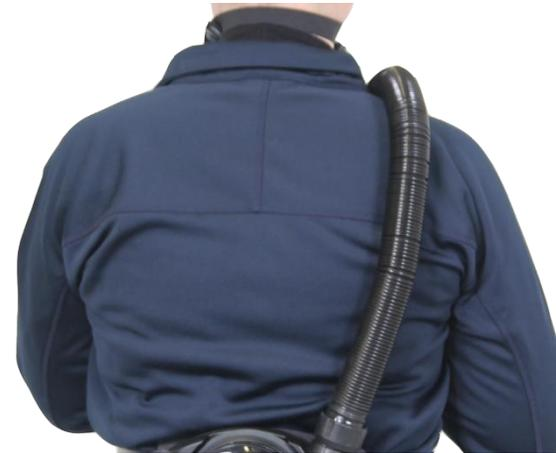
Bei Verwendung einer Halbmaske muss der Schlauch entlang des Rückens und über die Schultern geführt werden
