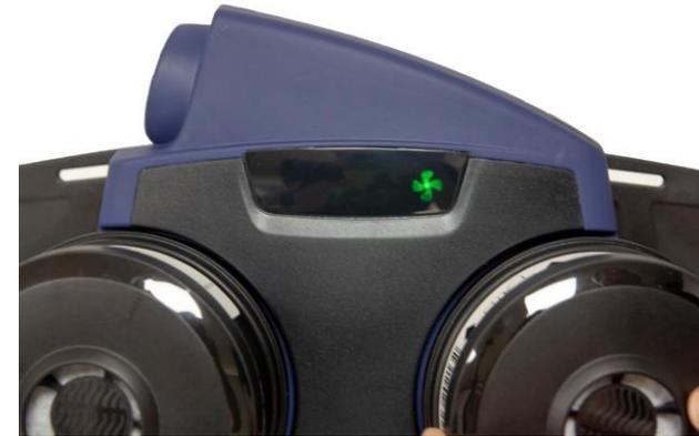
**4.3** Durch erneutes Drücken schaltet das Gebläse in den Volllastbetrieb mit mind. 225 l/min; es leuchtet das größere grüne Gebläse Symbol auf. Durch erneutes Drücken des Schalters wechselt das Gebläse wieder in den Normalbetrieb.
