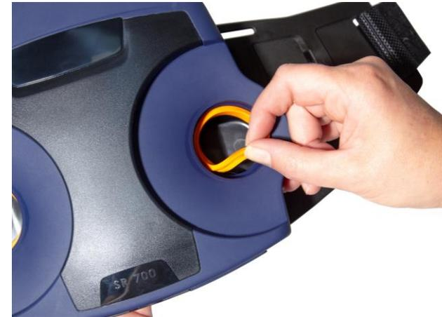
**11.1** Die Dichtung weist rundum eine Nut auf und ist auf einen Flansch aufgezogen, der sich unterhalb des Gewindes an der Filterfassung befindet. Entfernen Sie die alte Dichtung.
