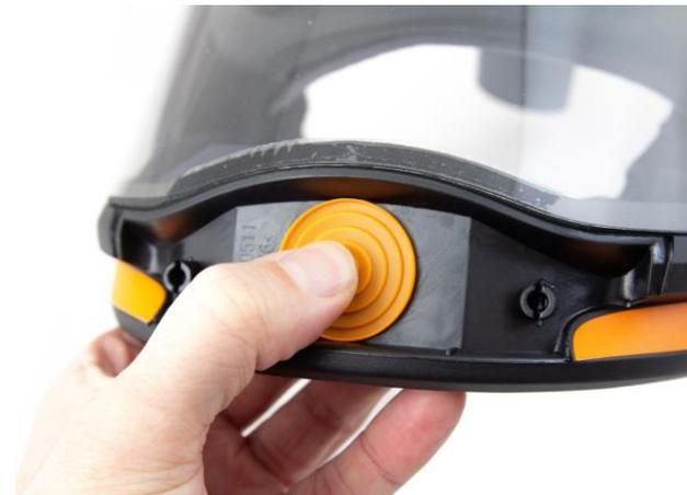
**7.4** Presser la nouvelle membrane sur la goupille. Vérifier soigneusement que la membrane est complètement en contact avec le siège de la soupape.
