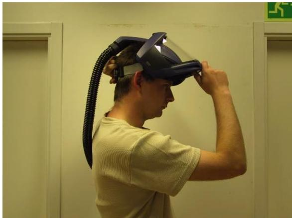
Bei Bedarf die Weite des Kopfgerüsts anhand des Dreh Knopfes an der Rückseite des Kopfgerüsts verstellen.
