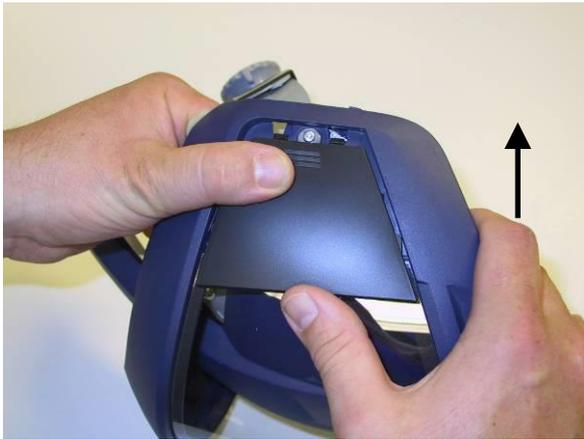
Abdeckklappen durch Einschieben mit den Fingern montieren. Ein Klickgeräusch zeigt an, dass sie eingerastet sind.
