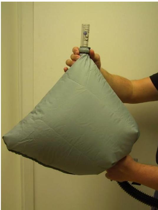
Halte den Gesichtsteil an die Tragetasche mit Strömungsmesser und schalte das Gerät ein.
