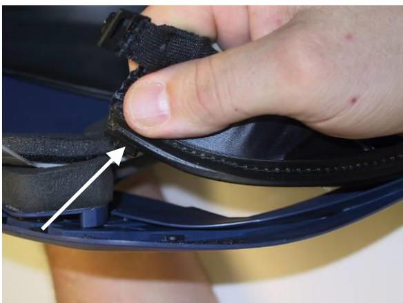
Gesichtsdichtung lösen, indem Sie am Rahmen ziehen, so dass die Zapfen aus den Öffnungen des Visiers befreit werden.
