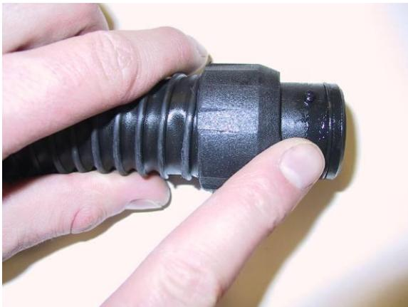
Kontrolliere dass der O-ring des Schlauches richtig montiert und unbeschädigt ist.
