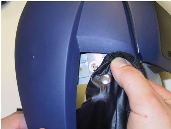
Die Kopfabdeckung unter den Luftkanal ziehen und mit den 4 Druckknöpfen befestigen.
