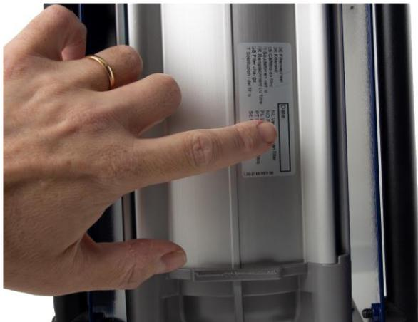
**1.4** L'élément filtrant est monté avant la livraison. Notez la date sur l'étiquette à l'extérieur du support du filtre. Il vous sera ainsi possible de connaître sa date de remplacement.
