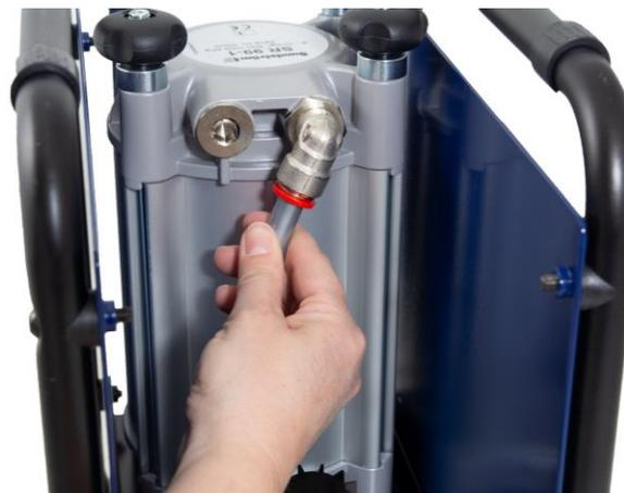
**2.8** Raccordez le flexible entre la vanne de régulation et le couvercle du filtre en poussant le flexible dans le connecteur
