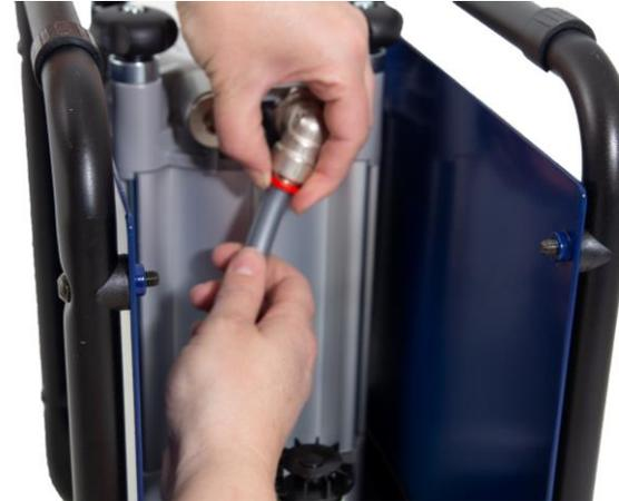
**2.2** Desserrez le tuyau entre le régulateur et le couvercle du filtre en poussant le manchon rouge sur le raccord et débranchez-le du couvercle.
