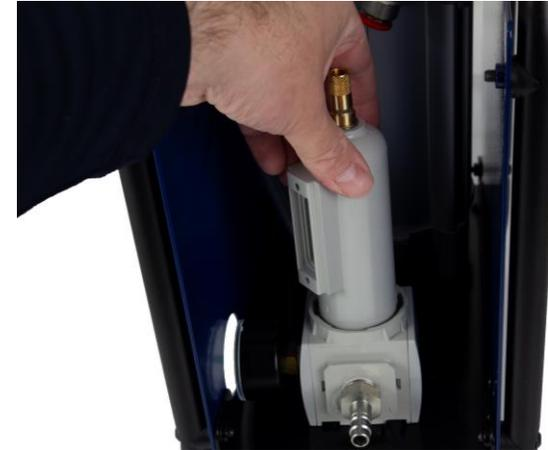
**4.2** Retirez la cuve de drainage. Exercez une pression vers le bas et tournez dans le sens contraire des aiguilles d'une montre (fixation baïonnette). Lavez la cuve à l'eau chaude (et non au solvant) à 60 °C maximum.
