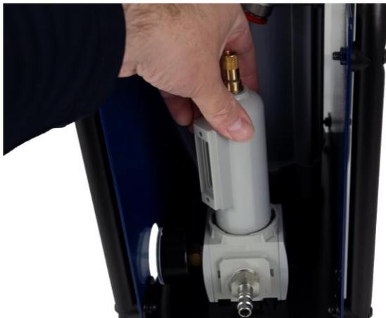
**3.2** Retirez la cuve de drainage. Exercez une pression vers le bas et tournez dans le sens contraire des aiguilles d'une montre (fixation baïonnette). Laver la cuve à l'eau chaude (et non au solvant) à 60 °C maximum.
