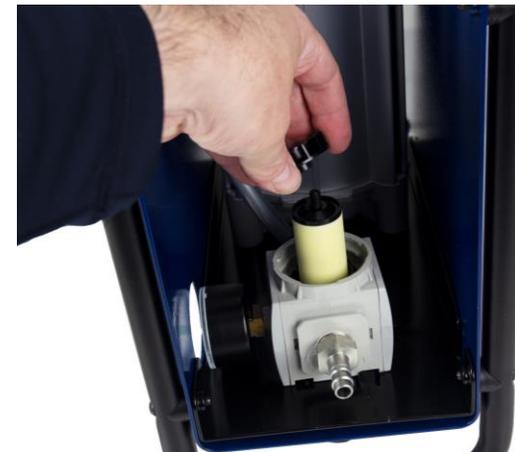
**4.3** Nettoyez les pièces à l'air comprimé. Vérifiez que la sortie de vidange n'est pas obstruée.
