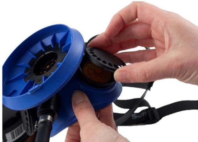
**10.1** Die Ausatemsmembrane sitzen an einem festen Zapfen innerhalb der Ventilklappen. Die Klappen sind gleichzeitig mit der Membran zu ersetzen. Ventilklappen von den Ventilsitzen abziehen.
