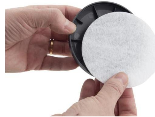
**3.3** Le pré-filtre empêche le filtre principal de se boucher prématurément. Le support de préfiltre évite d'endommager le filtre principal. N.B. Le préfiltre est un préfiltre uniquement et ne peut pas être utilisé en remplacement du filtre à particules.
