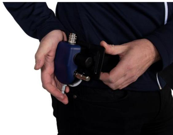
**4.2** Installez la soupape de réglage de façon à permettre un ajustement facile du débit d'air et une surveillance stricte du tuyau respiratoire. Il ne doit donc pas être placé derrière la ceinture.
