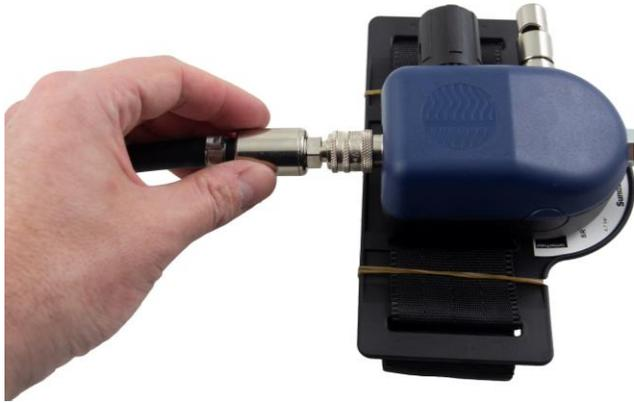
**1.4** Vérifiez que le débit d'air mesuré dans le masque est d'au moins 150 l/min.
