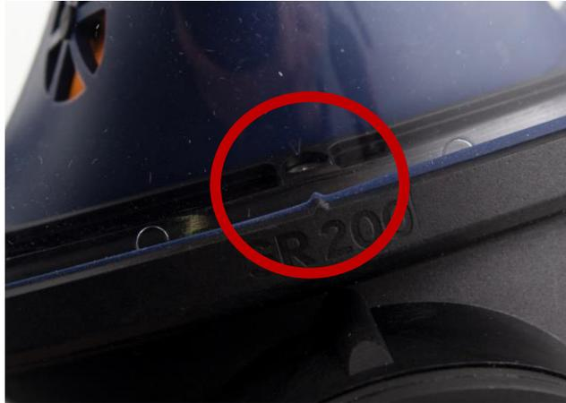
**12.4** La visière, les moitiés de cadre et le masque comportent un repère indiquant le milieu. Introduisez la visière neuve dans la cannelure de sorte que les repères indiquant le milieu coïncident. Pour faciliter le montage, humidifiez la cannelure à l'aide d'une solution savonneuse ou d'un liquide similaire.
