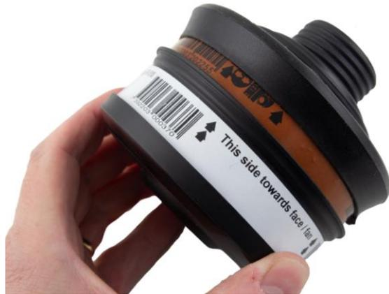
**3.2** Montez le filtre ou le filtre combiné sur le masque de sorte que les flèches tracées sur le filtre pointent vers le visage de l'utilisateur. Vérifiez attentivement que le bord du filtre est positionné dans la cannelure intérieure de la monture du filtre sur tout son pourtour.
