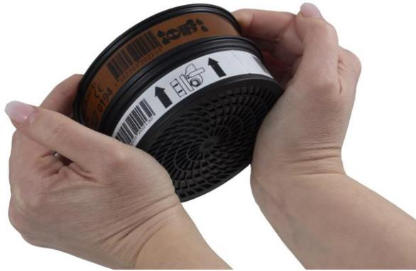
**3.1** Si vous travaillez dans une atmosphère contenant à la fois des particules et des gaz/vapeurs (comme la peinture au pistolet), vous devez combiner le filtre à particules et la cartouche chimique. Serrez le filtre/la cartouche ensemble de sorte que les flèches sur le filtre à particules pointent vers la cartouche chimique.
