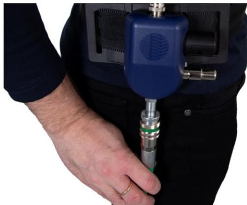
**9.2** Raccordez le flexible d'alimentation en air comprimé à la soupape de réglage.
