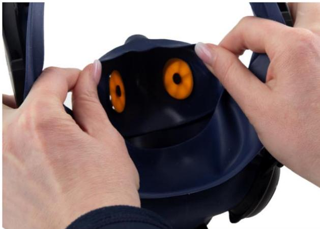
**13.2** Deux membranes sont montées sur la face intérieure du masque intérieur, une de chaque côté. Les tiges de ces membranes sont amovibles et doivent être remplacées en même temps que les membranes. Extrayez les membranes et les tiges.
