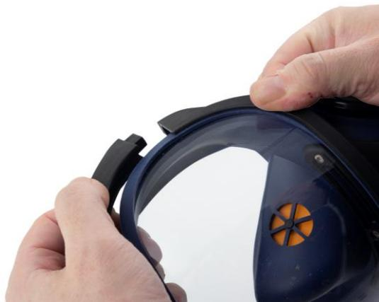
**12.2** Retirez avec précaution la moitié supérieure du cadre. Dégagez avec précaution la partie supérieure du masque de la visière et sortez la visière de la cannelure inférieure.
