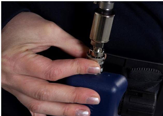
**11.2** Retirez la bague de verrouillage.
