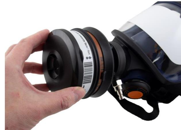
**3.4** Tournez les filtres dans le masque. Vissez jusqu'à ce que le filetage atteigne le joint au fond du raccord de filtre, puis faites pivoter de 45 degrés de plus.
