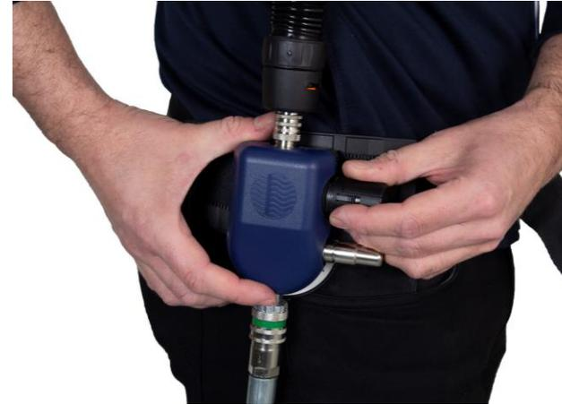
**2.7** Utilisez le bouton du robinet de réglage pour régler le débit d'air afin de l'adapter à l'intensité de votre travail. En position complètement fermée (dans le sens inverse des aiguilles d'une montre), le débit est d'environ 175 l/min. En position complètement ouverte (dans le sens des aiguilles d'une montre), il est d'environ 260 l/min.
