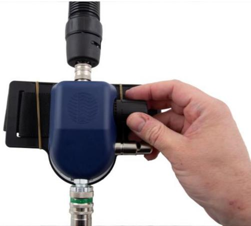
**1.4** Tournez le bouton du robinet de réglage à fond dans le sens inverse des aiguilles d'une montre afin de réduire le débit d'air au minimum.
