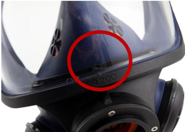
**6.4** Visier, Rahmenhälften und Maske haben eine Kennzeichnung, um die Mitte zu markieren. Das neue Visier so in die Nut einsetzen, dass die Mittelmarkierungen zusammenfallen. Um die Montage zu erleichtern, empfiehlt es sich, die Nut mit Seifenlösung o. dgl. anzufeuchten.
