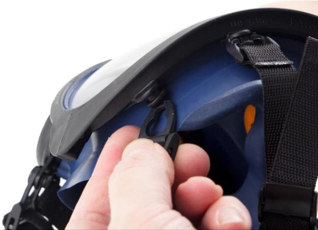
**9.1** Das Kopfgestell ist als Ersatzteil nur in kompletter Ausführung verfügbar. Bandhalterungen des Kopfgestells von den Bandhaltepunkten der Maske abziehen.
