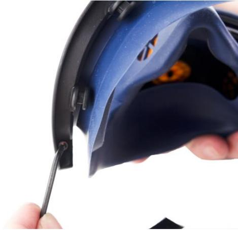
**6.1** Das Visier ist in einer Nut befestigt, die um die Visieröffnung der Außenmaske herum läuft und wird von einer oberen und einer unteren Rahmenhälfte gehalten. Die beiden Schrauben, mit denen die beiden Rahmenhälften miteinander verbunden sind, mit Hilfe eines 2,5 mm Innensechskantschlüssels lösen.
