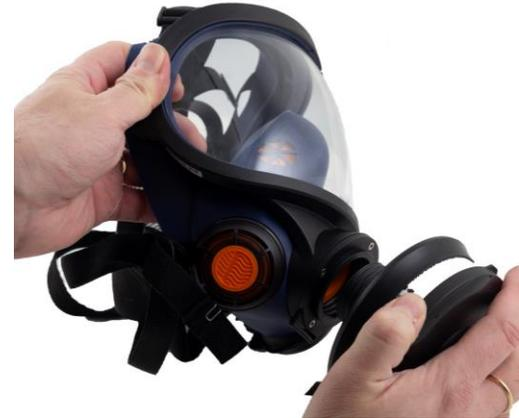
**2.3** Die Filter fest mit der Maske verschrauben. (bis zum Anschlag an die Dichtung und danach 1/8 Umdrehung).
