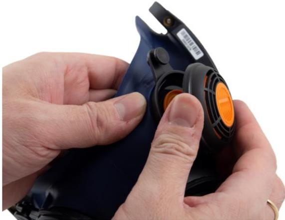
**8.1** Die Ausatemsmembrane sitzen an einem festen Zapfen innerhalb der Ventilklappen an beiden Seiten der Außenmaske. Die Klappen sind gleichzeitig mit der Membran zu ersetzen. Ventilklappen von den Ventilsitzen abziehen.
