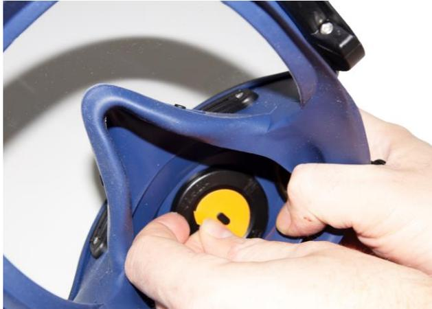
**7.1** Eine Membran sitzt im Zentrum der Innenmaske auf einem festen Zapfen. Membrane entfernen und durch eine neue ersetzen.
