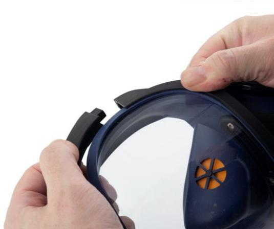
**6.2** Obere Rahmenhälfte vorsichtig abziehen. Den oberen Teil der Maske vorsichtig vom Visier herunterkrepeln und das Visier aus der unteren Nut herausheben. Reinigen Sie bei dieser Gelegenheit die Nut.
