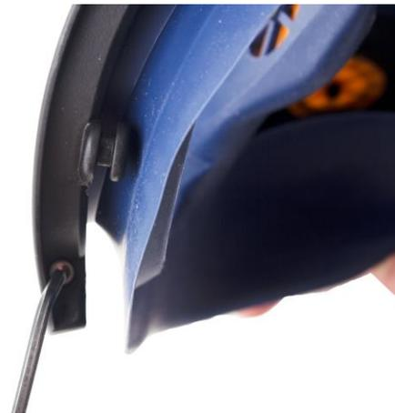
**6.7** Schrauben befestigen und Rahmenhälften wechselweise fest zusammenschrauben.
