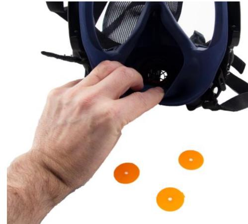
10.2 Einatemungsventile (drei) ausbauen. Kritische Bereiche sind die Ausatemsmembrane und die Ventilsitze, die saubere und unbeschädigte Kontaktflächen haben müssen. Inspizieren Sie alle Bauteile und tauschen Sie bei Bedarf mit neuen Teilen aus.
