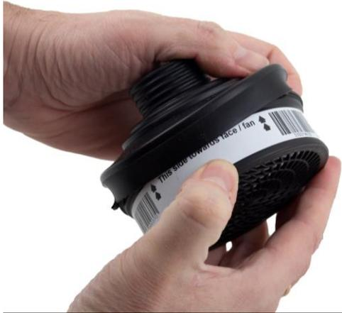
**2.1** Filter/Kombinationsfilter so in die Filteradapter einsetzen, dass die Pfeile auf dem Filter zum Gesicht hin zeigen. Achten Sie unbedingt darauf, dass der Filter rundum in der Innennut der Filterfassung zum Liegen kommt.
