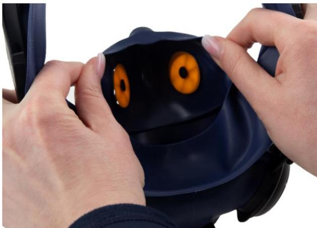
**7.2** Zwei weitere Membrane sitzen an der jeweiligen Innenseite der Innenmaske. Die Zapfen hierfür sind abnehmbar und sind gleichzeitig mit der Membran zu ersetzen. Membrane und Zapfen entfernen.
