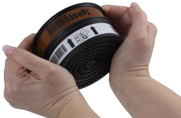
**1.2** Placez le filtre à particules au-dessus de la cartouche. Saisissez les deux protections. Appuyez fortement dessus jusqu'à entendre le filtre s'encliqueter sur le filtre à gaz.
