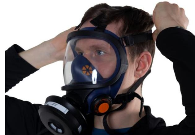
**4.4** Tendez les sangles élastiques par paire en tirant vers l'arrière sur l'extrémité libre des sangles. Ajustez le masque sur le visage de sorte qu'il soit positionné de manière stable et confortable. Ajustez la longueur de la paire de sangles supérieures et bloquez-la avec les boucles.
