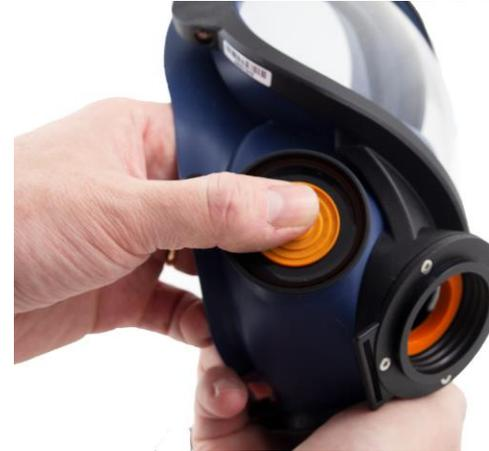
**8.3** Pressez la nouvelle membrane sur les tiges. Assurez-vous que les membranes s'appliquent exactement sur le pourtour du siège de la valve.
