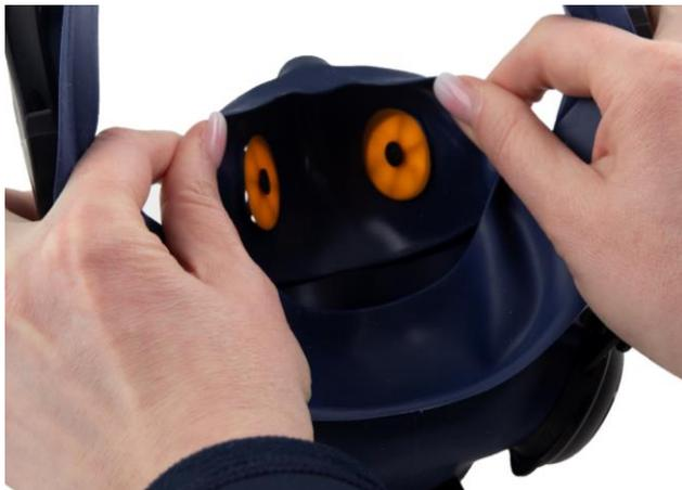
**7.2** Deux membranes sont montées sur la face intérieure du masque intérieur, une de chaque côté. Les tiges de ces membranes sont amovibles et doivent être remplacées en même temps que les membranes. Extrayez les membranes et les tiges.
