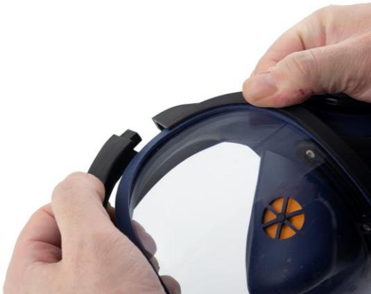
**6.2** Retirez avec précaution la moitié de cadre supérieure. Dégagez avec précaution la partie supérieure du masque de la visière et sortez la visière de la cannelure inférieure.
