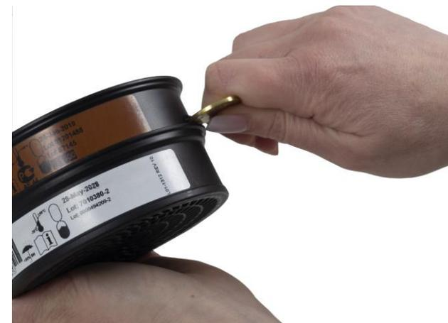
**1.4** Placez une pièce de monnaie dans l'espace entre la lèvre inférieure du filtre à particules et le petit onglet moulé sur le côté du filtre à gaz. Poussez fermement et faire levier avec la pièce jusqu'à ce que le filtre se désolidarise.
