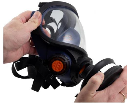
**2.3** Tournez les filtres dans le masque. Vissez jusqu'à ce que le filetage atteigne le joint au fond du raccord de filtre, puis faites 45 degrés de plus.
