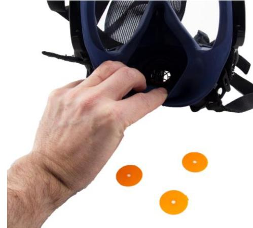
10.2 Retirez les membranes d'inspiration. Les éléments critiques que sont les membranes d'expiration et le siège des valves doivent présenter des surfaces de contact propres et intactes.
