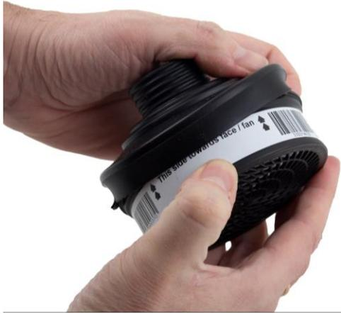
**2.1** Montez le filtre ou le filtre combiné sur le masque de sorte que les flèches tracées sur le filtre soient tournées vers le visage de l'utilisateur. Vérifiez avec soin que le bord du filtre est positionné dans la cannelure intérieure de la monture du filtre sur tout son pourtour.
