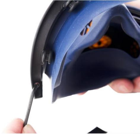
**6.1** La visière est insérée dans une cannelure qui fait le tour de l'ouverture de la visière dans le masque extérieur et est maintenue en place par un demi-cadre supérieur et inférieur. Déposez les deux vis qui maintiennent ensemble les moitiés de cadre au moyen d'une clef Allen de 2,5 mm.
