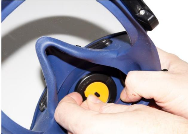
**7.1** Une membrane se trouve au centre du masque intérieur, montée sur une tige fixe. Extrayez la membrane et montez-en une neuve.
