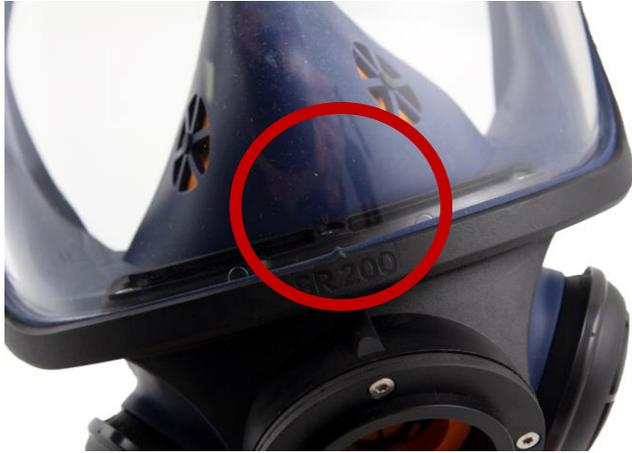
**6.4** La visière, les moitiés de cadre et le masque comportent un repère indiquant le milieu. Introduisez la visière neuve dans la cannelure de sorte que les repères indiquant le milieu coïncident. Pour faciliter le montage, humidifiez la cannelure à l'aide d'une solution savonneuse ou d'un liquide similaire.
