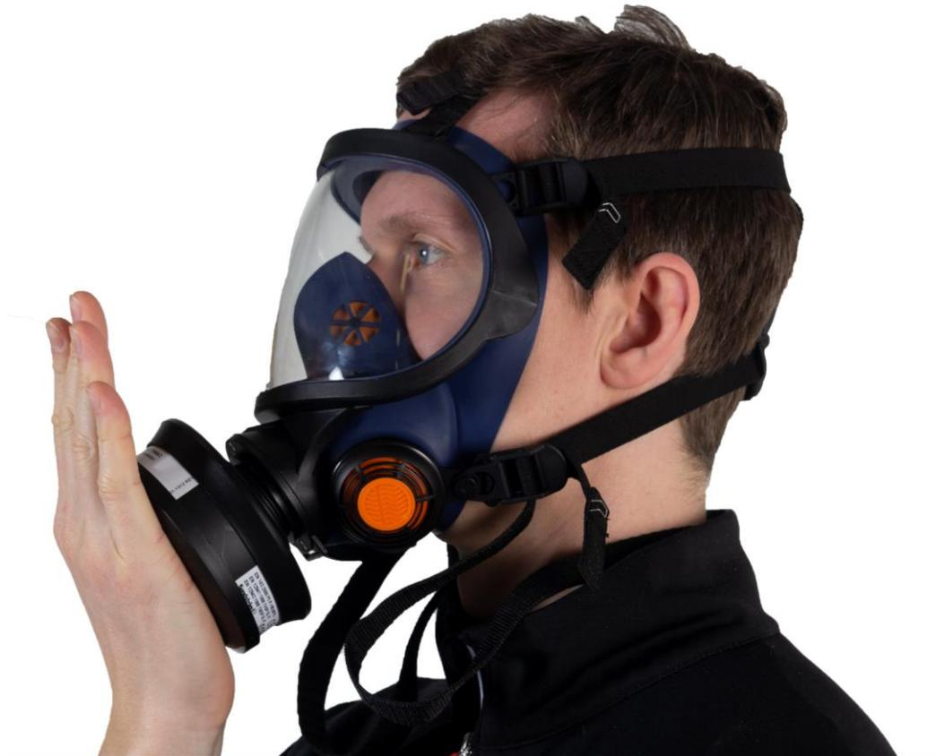
**5.1** Placez le porte-préfiltre sur le filtre. Mettre le masque. Pressez légèrement la paume de la main sur le trou du porte-préfiltre afin de créer l'étanchéité.
