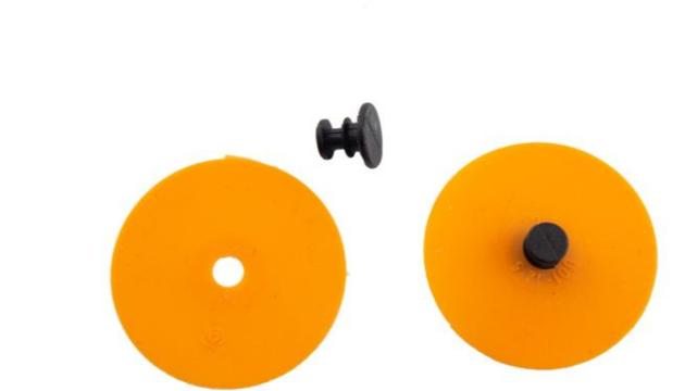
**7.3** Comprimez les membranes neuves sur les tiges. La membrane doit reposer sur la bride la plus large. Par conséquent, vous devez d'abord introduire la tige avec la membrane à partir de l'intérieur du masque à travers le siège de la valve avec la bride la plus étroite.
