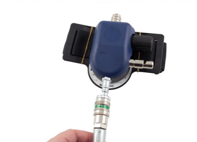
1.3 Anslut tryckluftslangen till reglerventilen.
